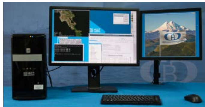
ЗОСРВ «Нейтрино-Э» на ВК Эльбрус 401-РС на базе процессора Эльбрус-4С
