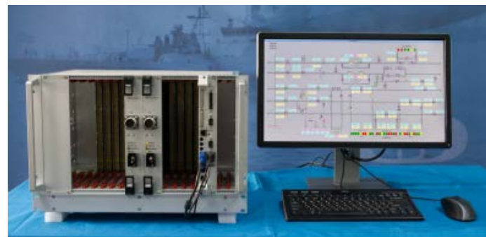
ЗОСРВ «Нейтрино-Э» и СДКУ «Фокус» на ВК MBKUB/C с 2-процессорной системой Эльбрус-2С+
